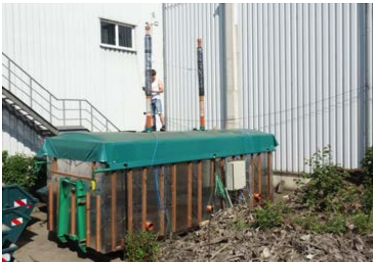
Afbeelding 2: voorbeeld van biomeiler in container , met warmtewisselaar aan de zijkant.
